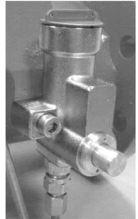
Afb. 8 | Oliepomp met drukknop
