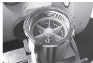
Fig. 5 | Serbatoio di contenimento dell'olio
